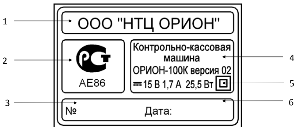
Рисунок 3 – Шильдик ККМ «ОРИОН–100К версия 02».
